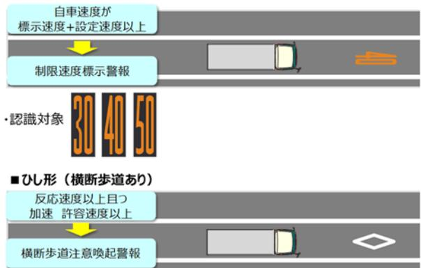
図-4 路面標示警報の機能イメージ
