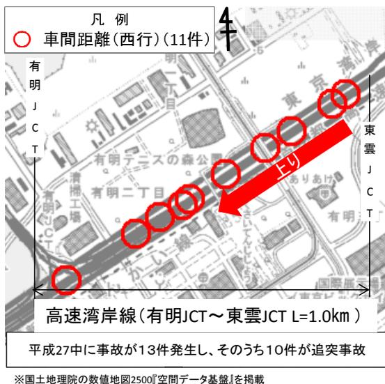
図-8 首都高 高速湾岸線 有明JCT～東雲JCTにおける車間距離警報発生箇所
