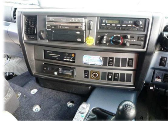
図-2 DTG7車載器の設置後の様子(車内)
